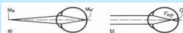
Рис. 7.3. Миопичный глаз (при покое аккомодации): а) дальняя точка ясного видения; б) фокус
